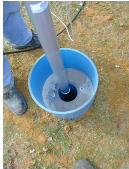
Installation der Neigungsmesser (Empfindlichkeit 0,1 \mu rad)
