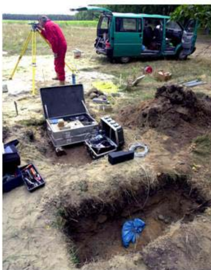
Abb. 15: Netzwerk zur Registrierung der induzierten Seismizität. Oben links: Lage der seismischen Stationen, oben rechts: Bohren einer seismischen Beobachtungsbohrung mit dem Gerät des LBEG, unten links: Aufbau einer Registrierstation, unten rechts: Dreikomponenten-Geophonsonde
