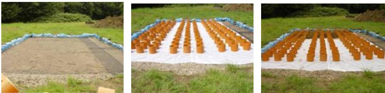
Abb. 10: Installation der Freilandanlage (von links nach rechts): Kiesbett mit Sandauflage und Geotextil, Gaze und Töpfe, Auffüllung mit Boden
