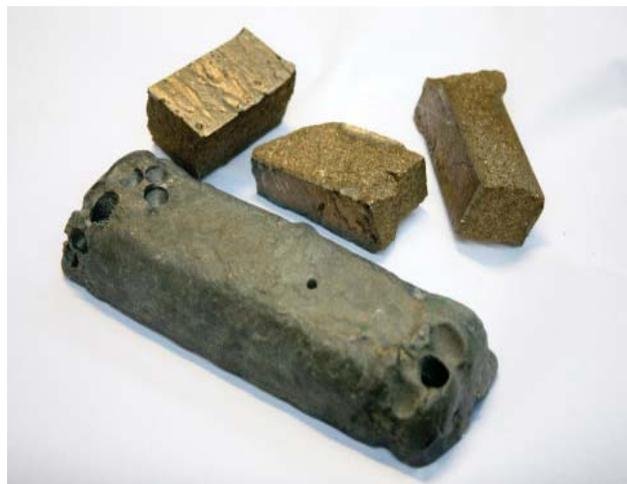
Abb. 1: Nd-Fe- und Dy-Barren, Foto: Vacuumschmelze GmbH & Co. KG, Hanau
